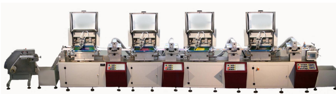
Macchina serigrafica 'Screen 4 colours' per la stampa di etichette autoadesive.
